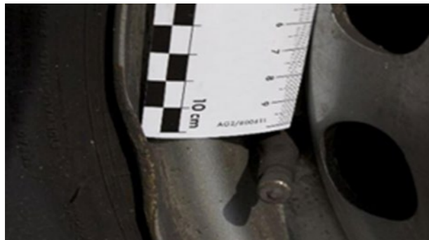
Op stalen velg: Bevestigingsrand licht vervormd
