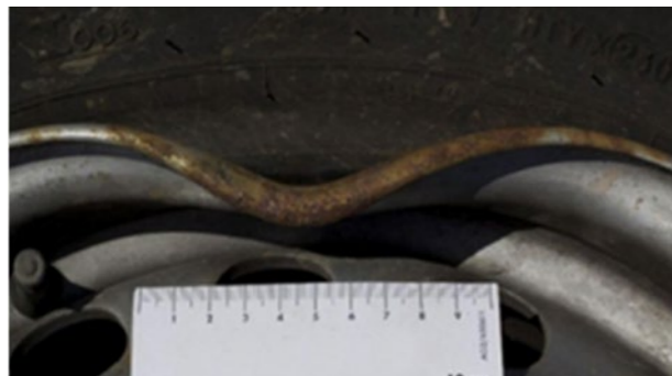
Velgbed beschadigd, niet goedgekeurde velg. Beoordeling van de afmetingen om de veiligheid van het voertuig te controleren
