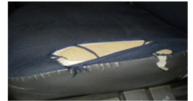
Brandplek > 3 mm, perforatie of scheur in de bekleding, zonder beschadiging van de opvulling
