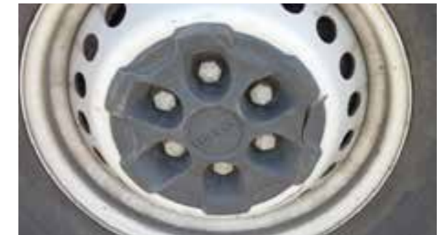
Wieldoppen: Vervormd, gebroken, materiaal ontbreekt of compleet verwijderd
