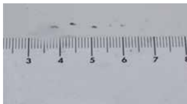
Blus \leq 5 mm in diameter en \leq 20 steenslagschades
