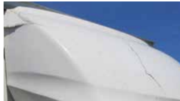
Cabine en windgeleider: Duidelijke scheur, ontbrekend onderdeel of niet meer economisch te repareren
