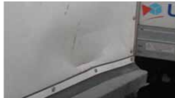
Zij- en achterdeuren: Ernstige vervorming: Reparatietijd > 1 u economisch verantwoord te repareren, sluiting niet verzegeld
