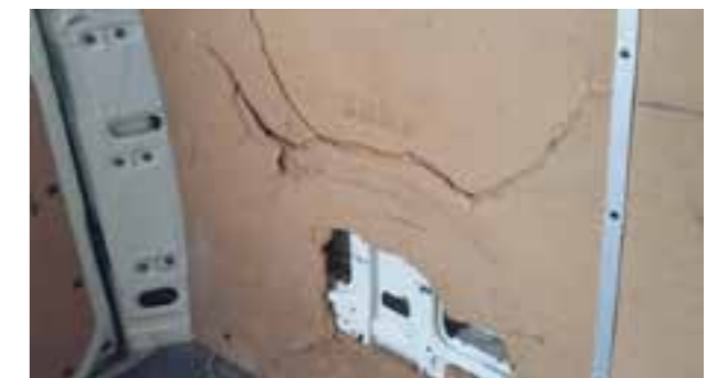
🔄 Houten binnenbekleding: Deuken, gescheurd paneel, paneel ontbreekt (exclusief bovenste deurpanelen)
