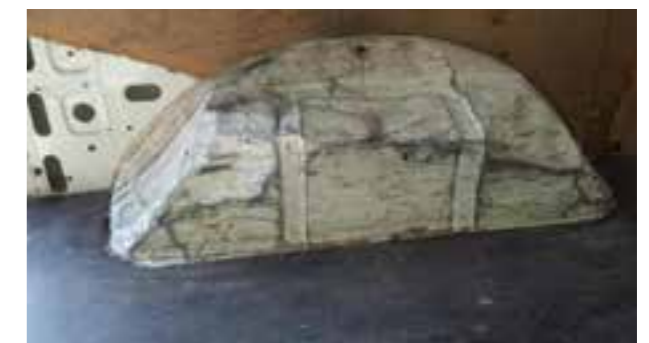
🔄 Vervorming aan de binnenzijde: Perforaties, insnijdingen, vervormingen niet economisch verantwoord te repareren. Denaturerende en niet-corrigeerbare afzetting (poeder, verf, enz.) (Wielkuip niet te repareren als reparatietijd < 3u)
