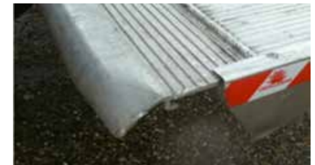
Laadklep: Vervormingen van laadklep economisch verantwoord te repareren
