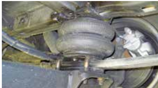
Lichte sporen van olie (niet druppelen)
