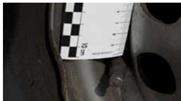
Op stalen velg: Bevestigingsrand licht vervormd
