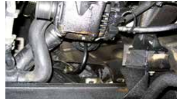
Lekken van het stuurhuis en de stuurbekrachtigingspomp
