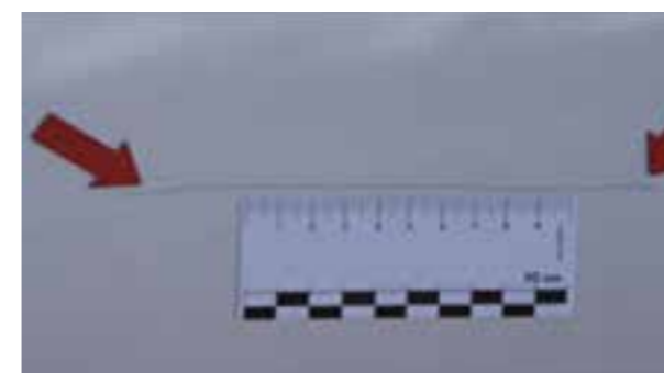
Krassen > 20 mm NB: Openslaande achterdeuren kunnen niet per half paneel worden gespoten
